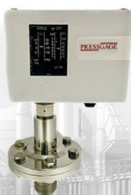
Pressostato de ajuste diferencial com contato SPDT e selo diafragma
